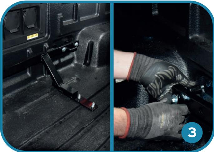
NL: Plaats steun A (2X) ter hoogte van de sjorogen vooraan. Gebruik hiervoor de spacers en de lange schroeven en het sjorooog. Draai nog niet volledig vast.
