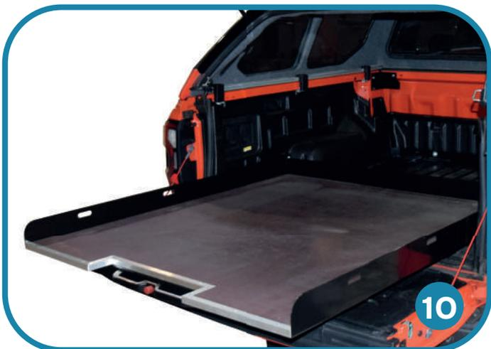
NL: Draai alle schroeven vast van steun A en B en controleer of de schuifplateau vlot open en dicht gaat.
