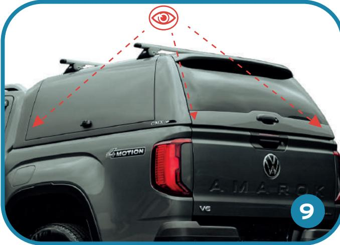
NL: **Lijn de hardtop uit** op de achterkant van de wagen en zorg ervoor dat de rubber van de hardtop goed aansluit.
