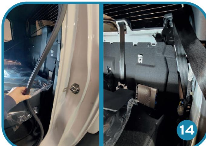
NL: Verwijder het rubber aan de binnenkant van de deur en daarna de instaplijst en de afdekkappen.
