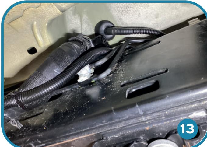
NL: Sluit hierna kabelboom (b) aan op punt 2 van kabelboom (a).
