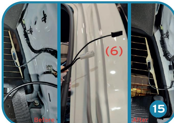
NL: Ontkoppel van boven de originele stekker voor de achterruitverwarming en koppel hier punt (6) van kabelboom (b) op aan.
