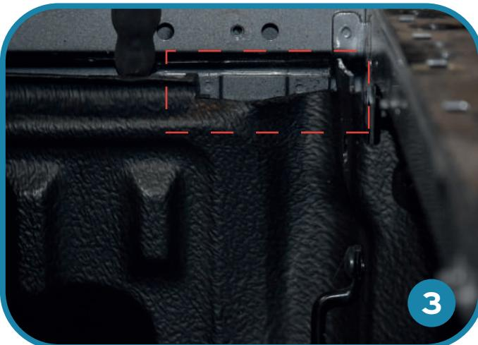
NL: **Snij de bedliner bij.** Maak een inkeping tot voorbij het schroef gat, aan beide zijden.
