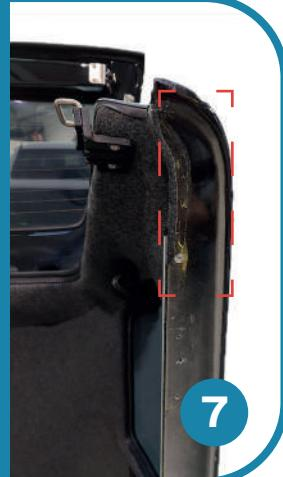
NL: Snij een stuk van de binnenbekleding langs beide zijden in de bovenste hoeken van de Type E+ Air en ontvet de onderkant van de hardtop.
